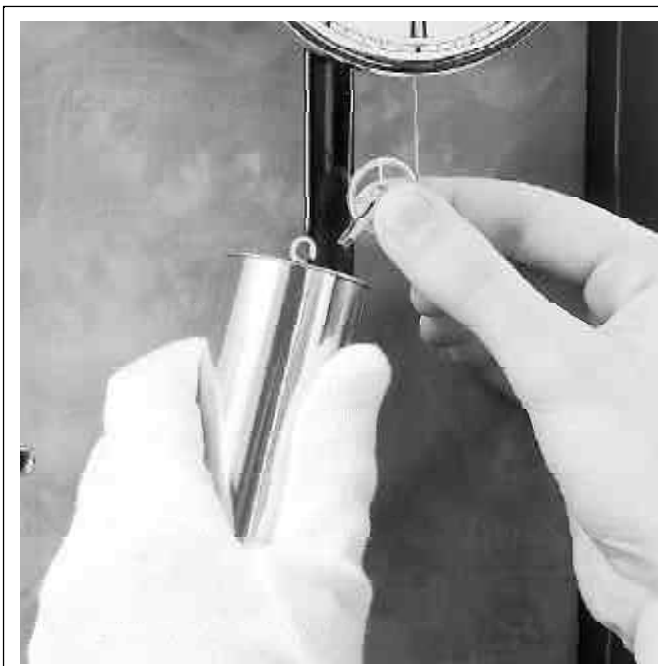
Bild 6 / Picture 6 / Figure 6 / Ilustración 6 Einhängen Gewichte (Miniaturen) Hanging the weights (miniatures) Suspension des poids (miniatures) Suspensión de pesas (miniaturas)
