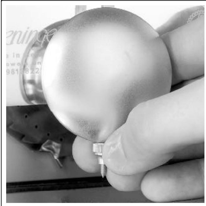
Bild 9 / Picture 9 / Figure 9 / Ilustración 9 Das Pendel einregulieren Adjusting the pendulum Ajustage du pendule Ajustar de la péndola
