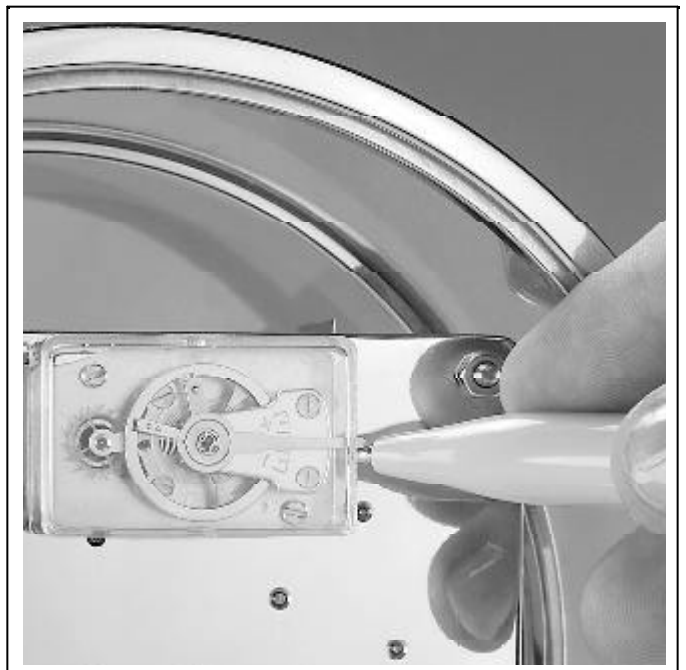
Bild 8 / Picture 8 / Figure 8 / Ilustración 8 Einstellen des Echappements Adjusting the escapement Réglage de l'échappement Ajustar el escape
