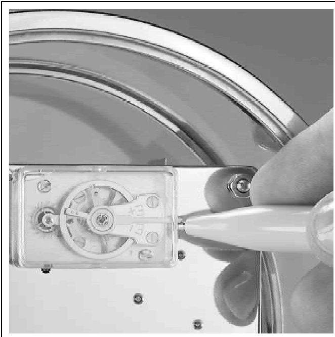
Bild 5 / Picture 5 / Figure 5 / Ilustración 5 Einstellen des Echappements Adjusting the escapement Réglage de l'échappement Ajustar el escape
