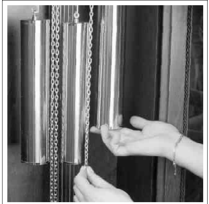
Bild 11 / Picture 11 / Figure 11 / Ilustración 11 Die Uhr aufziehen (Kettzugwerke) Winding the clock (chain movements) Remonter l'horloge (mouvements à chaînes) Dar cuerda al reloj (movimientos a cadenas)
